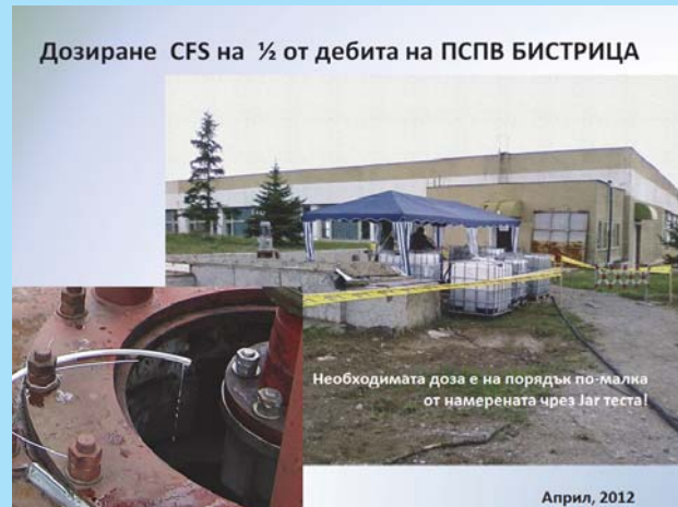
Фиг. 2. Снимка на опитната постановка за подаване на CFS към половината дебит на ПСПВ Бистрица
