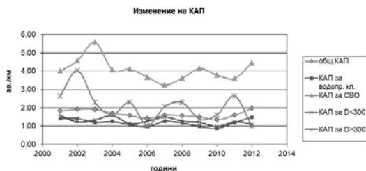
Фиг. 3. Разпределение на коефициента на аварийна плътност за град Видин от 2001 до 2012 г.
