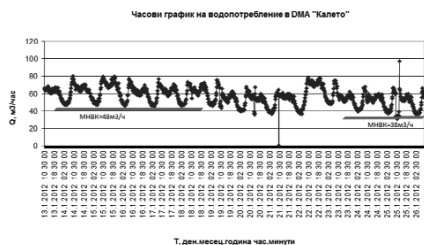
Фиг. 4. Анализирани на МНВК за DMA „Калето“ с цел определяне на дебита на изтичане
