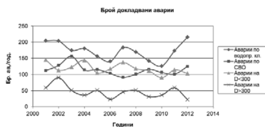
Фиг. 2. Разпределение на докладваните аварии в град Видин от 2001 до 2012 год.
